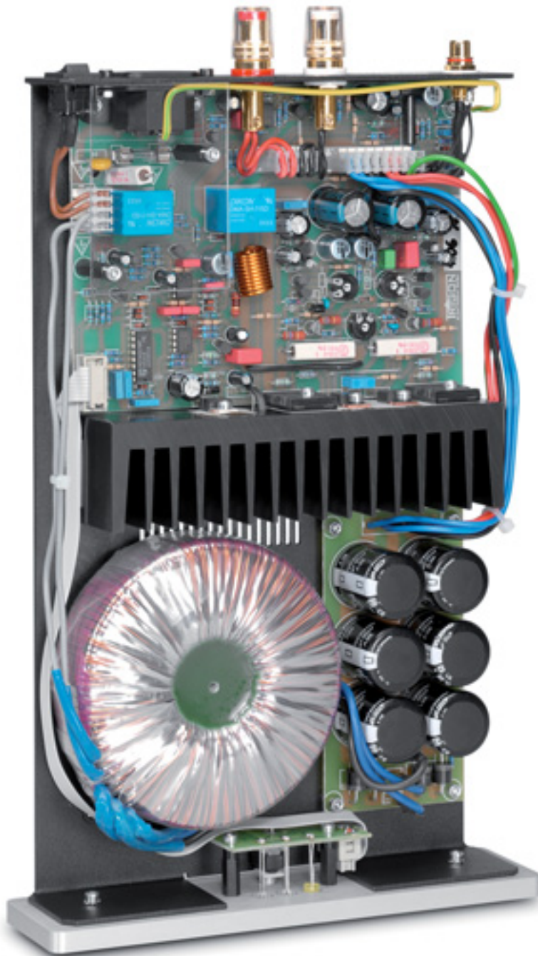
Selbst im flachen Dwarf-Gehäuse findet sich noch genügend Platz für einen kräftigen Ringkerntrafo
