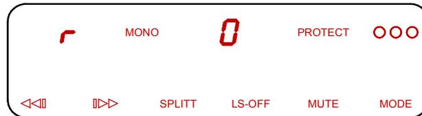
Um den Pre-Ausgang zum Record-Ausgang umzuschalten, drücken Sie in diesem *Menue* den Lautstärkedrehknopf so lange (ca. 3 Sekunden während die LED's [6] und [8] blinken), bis die "0" in der Anzeige [4] auf "1" wechselt.
