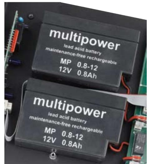
Zur endgültigen Ausschaltung jeglicher Störeinflüsse aus dem Stromnetz kann der Trigon Advance auf reine Akku-Stromversorgung umgeschaltet werden. Dabei kommen besonders „ruhige“ Blei-Gel-Akkus zum Einsatz
