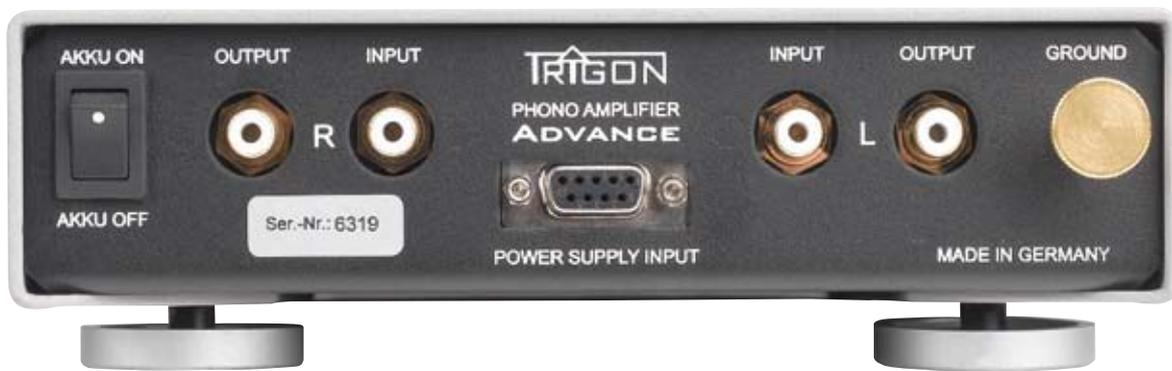
Die Rückseite bietet die üblichen Anschlüsse – Ein- und Ausgänge sind schaltungsspezifisch kanalgetrennt. Ein Lob verdient die sehr stabile Erdungsklemme. Das Netzteil wird über einen neunpoligen Spezialstecker angeschlossen und fest verschraubt
