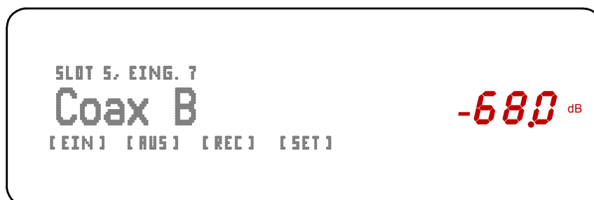
Displayanzeige, wenn der Coax Eingang B angewählt ist.
